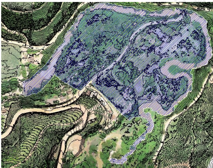
Figura 6: Área de inundação da barragem proposta (cota 105)
