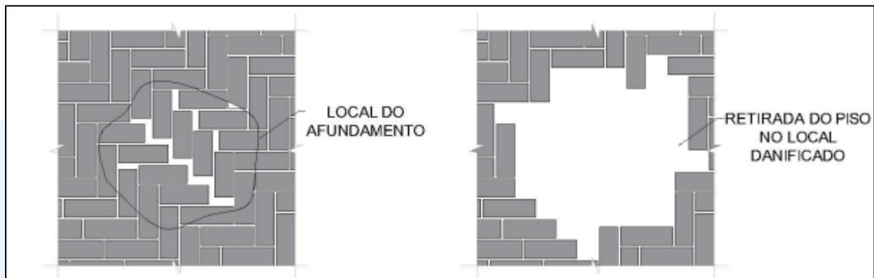
Figura 9 – Procedimentos da recuperação da pavimentação.
