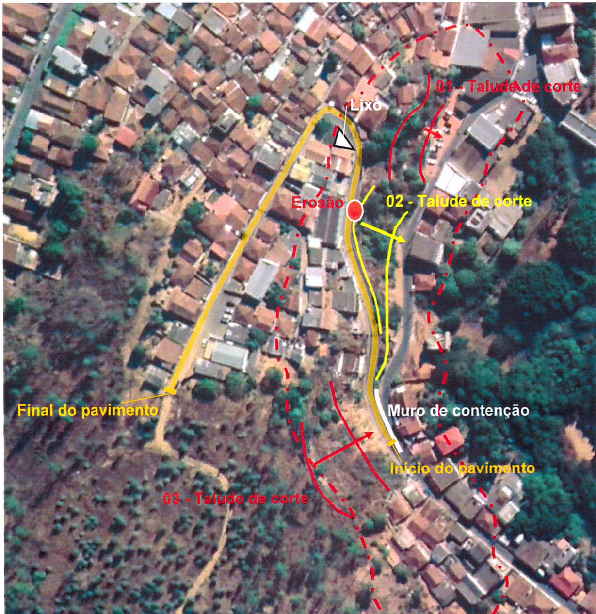
IMAGEM 01 – Imagem de satélite com a localização da área vistoriada, pertencente ao Bairro Nossa Senhora das Graças, zona urbana de São Roque do Canaã. Na imagem estão representados: a delimitação da área de risco mapeada pela CPRM (linha vermelha tracejada), três pontos onde foram identificados taludes de cortes, a localização de um muro de contenção, o início e final do pavimento intertravado de concreto, ponto de armazenamento de resíduos sólidos (lixo), ponto de erosão
